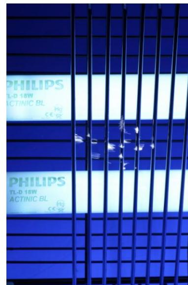
为了达到一次性击毙苍蝇等飞虫，残骸不挂网，并立即落入收集盘的效果，所以电网电压要达到4500-5000V，电网电流在10-12mA之间。
