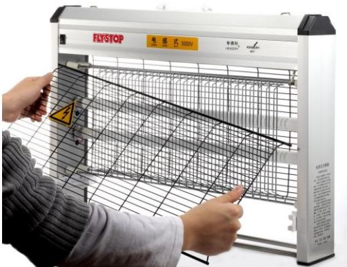
在更换灯管时，断开电源，将护网底部卡槽松开，就能把护网卸下并取出。
